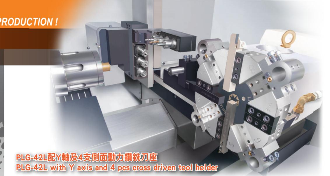
PLG-42L配Y軸及4支側面動力鑽銑刀座
